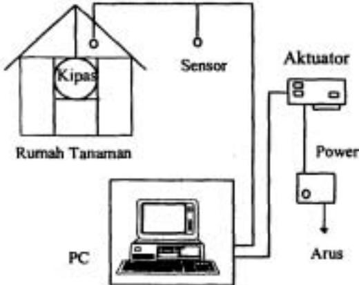
Gambar 2 . Skema Pengontrolan Suhu dalam Model Rumah Tanaman
