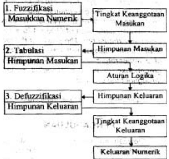
Gambar 1 Skema Perancangan Sistem Kontrol Fuzzy
