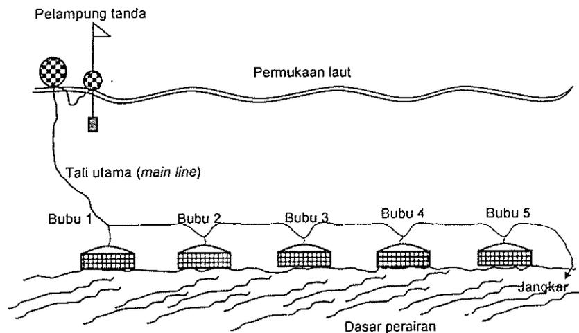
Gambar 3. Metode penempatan bubu sistem *long line*
