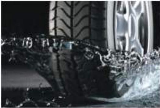
**Gambar 95** Ban kendaraan yang memecah tegangan permukaan air dan tetap mencengkeram permukaan jalan
