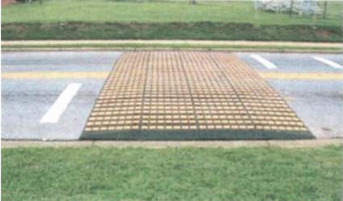
**Gambar 36** Polisi tidur untuk laju kecepatan kendaraan maksimal 40 km/jam
