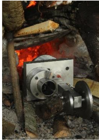
Gambar 4. Implementasi stirling engine di mitra
