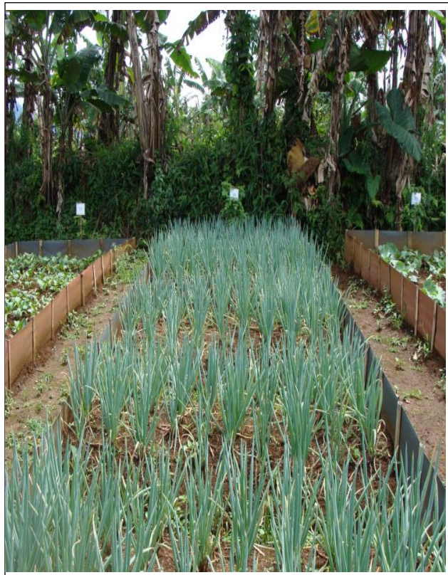
Gambar 3. Plot erosi tanah dengan jenis tanaman bawang daun (penanaman memotong lereng)
