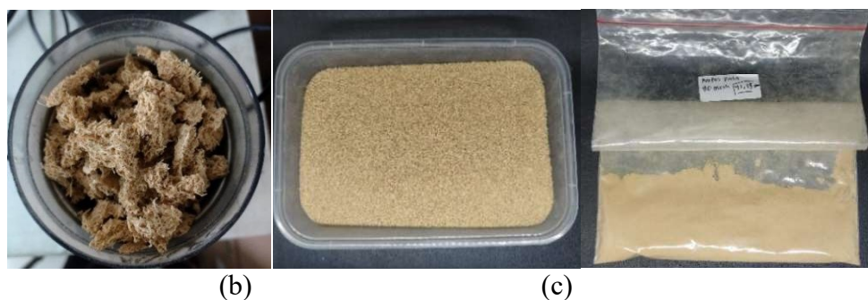
Gambar 12. (a) ampas pala setelah dikeringkan, (b) serbuk ampas pala setelah di giling, (c) serbuk ampas pala penyaringan 80 mesh
