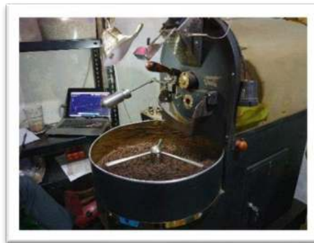
Gambar 5.20. Penggunaan software pada proses pemanggangan kopi
