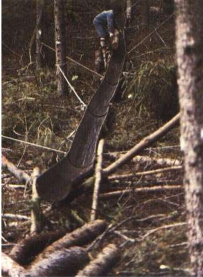
Gambar 2. Peluncur kayu yang terbuat dari plastik Leykam Log Line (Courtesy: FAO)
