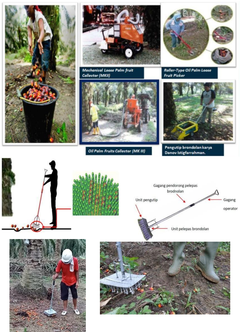
Gambar 3 Alat Pengutip Brondolan ERBRON-C
