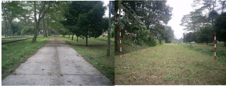
Gambar 1. Lintasan beton dan rumput tempat uji kinerja tarik traktor
