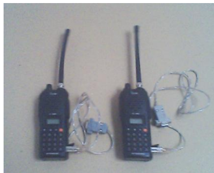
Gambar 4. Modul sistem pengirim ICOM V82 yang dilengkapi dengan kabel serial
