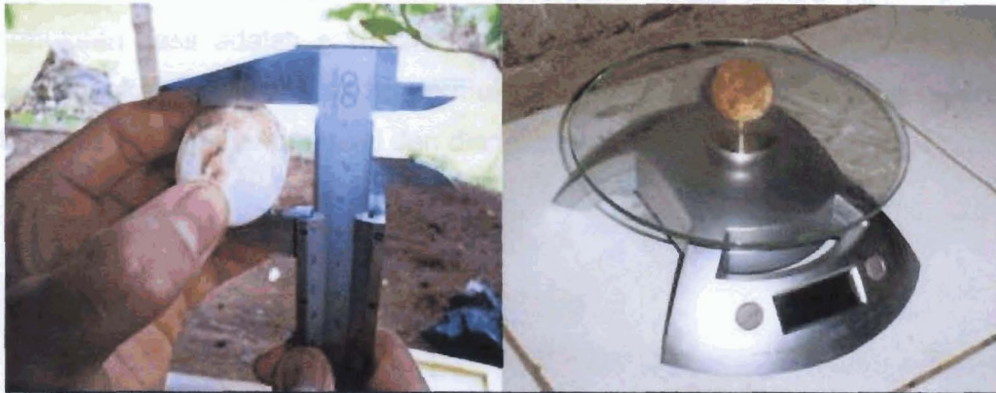
Gambar 7. Pengukuran diameter telur (kiri) dan pengukuran berat (kanan)
