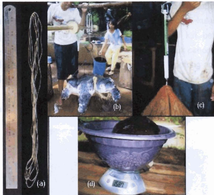
Gambar 4. Alat-alat yang digunakan untuk mengukur karakteristik morfologi: Penggaris dan benang bangunan (a); timbangan dacin (berat >10 kg) (b); timbangan pegas pesola 10 kg (berat 5–10 kg) (c); dan timbangan digital Tanita tipe KD-403 (berat ≤ 5 kg) (d).
