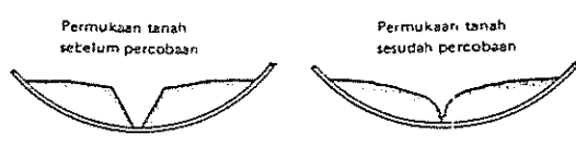
(D) Penampang contoh tanah sebelum dan sesudah selesai percobaan.
