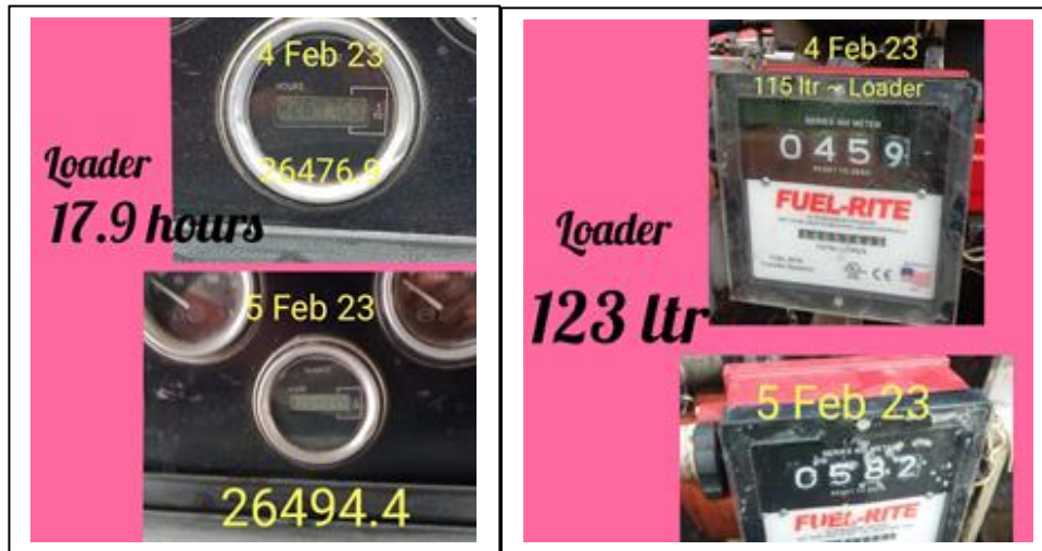
Gambar 54. pencatatan volume bahan bakar dan mesin hour
