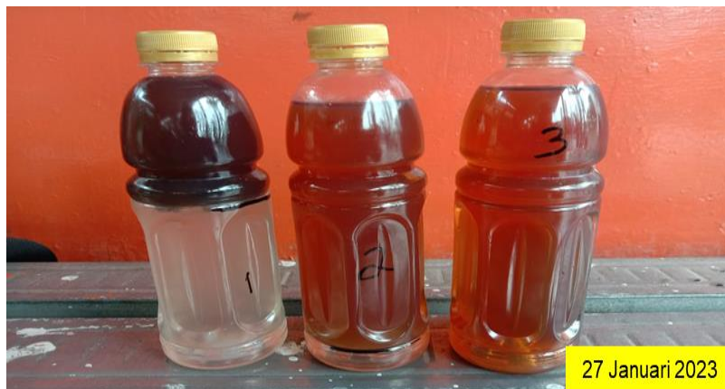
Gambar 59. Efektivitas aditif dalam memisahkan kontaminan didalam daily tank
