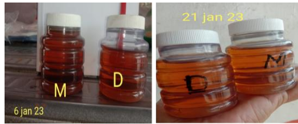
Gambar 58. Sampel bahan bakar dari main tank (M) dan daily tank (D)
