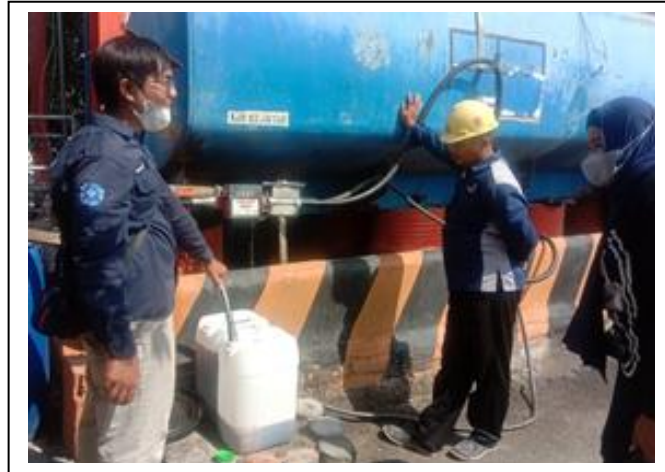
Gambar 52. Pelaksanaan kalibrasi flowmeter di VUB dengan mengacu pada flowmeter eksisting
