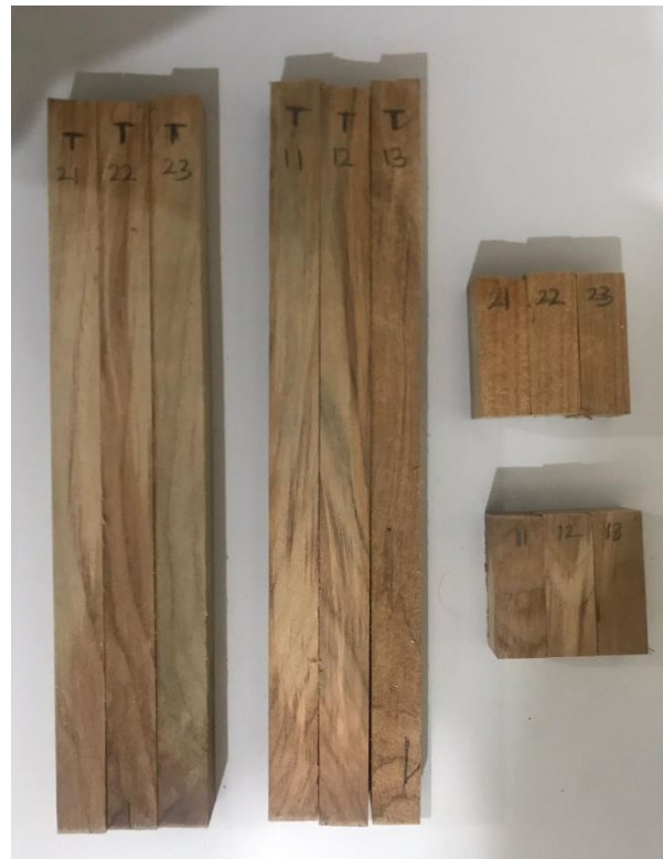
Dokumen 2 Sampel uji sifat mekanis. Yang diuji hanya Sampel 11, Sampel 21 (bersumber dari Sampel A dan B)
