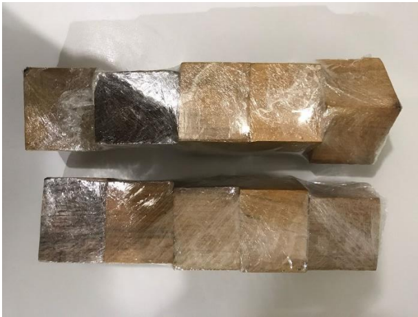
Dokumen 1 Labeling Sampel Kayu Uji Kadar Air dan Berat Jenis
