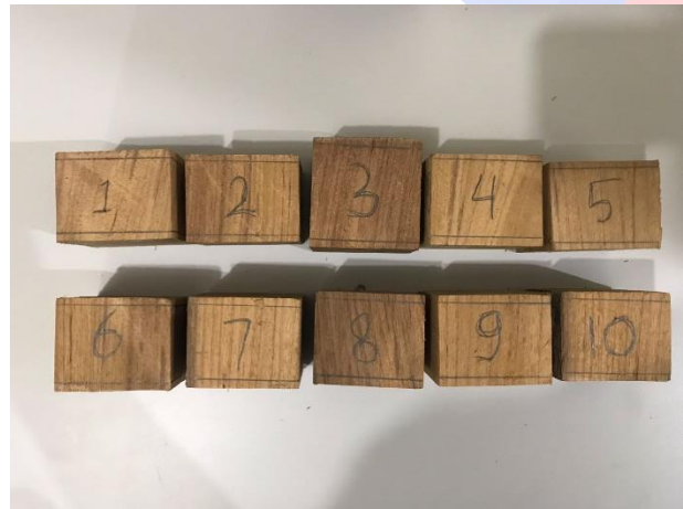
Dokumen 1 Labeling Sampel Kayu Uji Kadar Air dan Berat Jenis
