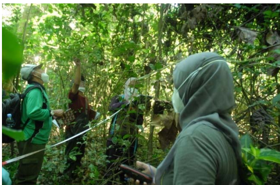
Pengukuran jarak pohon dengan titik patok (titik awal)
