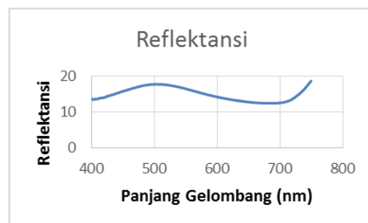
Gambar 2. Karakteristik reflektansi film tipis BST di atas substrat Corning Glass 7059 .
