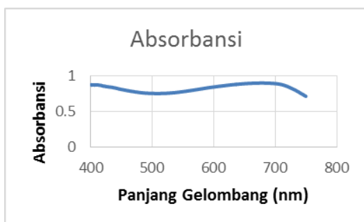
Gambar 1. Karakteristik absorbansi film tipis BST di atas substrat Corning Glass 7059 .
